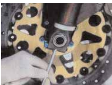
Règlage de la compression (toujours en bas sur les fourches, qu'elles soient standards ou inversées).
