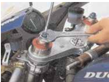
Le tournevis règle la vis de détente, la clef règle la précontrainte du ressort de la fourche.
